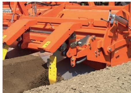
Die Vertiefungen können nach Wunsch eingestellt werden und sind unabhängig von der Fahrgeschwindigkeit. Produktfreundlich, minimale Beschädigungen an den geformten Dämmen.
