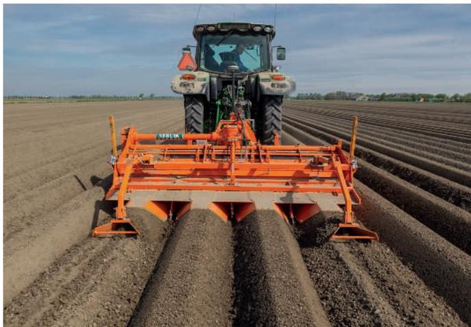
Mit den hydraulischen oder von Hand ausklappbaren Fahrgassenräumern lassen sich schnell und einfach Fahrspuren anlegen.
