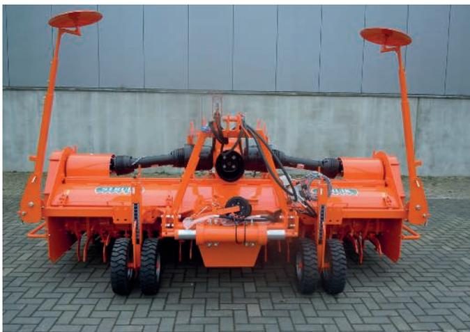
Durch die Verwendung eines Standardrahmens, ist die RF-Fräse mit einem doppelseitigen Antrieb in Kombination mit einem wartungsfreien Mittellager und einer Dreipunktaufhängung Kat. 3 lieferbar.
