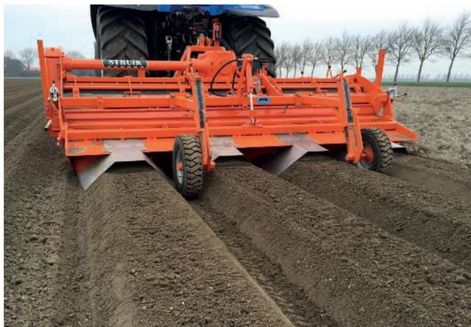
Einsatzbleche aus rostfreiem Stahl an den Andrückeinheiten zum Herstellen von ebenen Dammoberflächen. Es kann direkt hinein gepflanzt werden.
