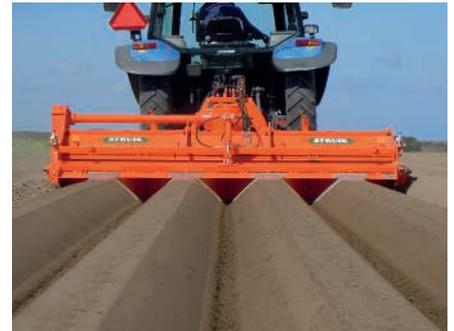
Das Dammformsystem von Struik sorgt für voluminöse Dämme mit einem Inhalt von etwa 620 cm<sup>3</sup>.
