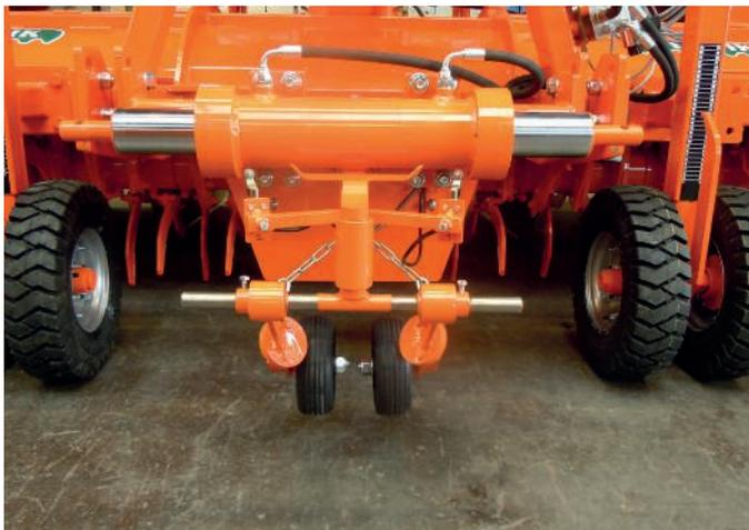
Durch die hydraulische Steuerung liegen die vorher gepflanzten Kartoffeln direkt in der Damm-Mitte, dadurch sinkt die Zahl der grünen Knollen.
