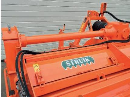
Die Hakenfräse RF wurde für Traktoren mit großer Leistung entwickelt. Der Antrieb erfolgt über ein Kegelradgetriebe in Kombination mit einem Kettengetriebe.
