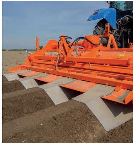
Das Dammformblech kann mit einer automatischen Steuerung ausgestattet werden, die einen konstanten Druck auf das Dammformblech bewirkt, wodurch die Dämme fest und gerade werden.
