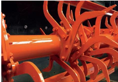
Um den Boden optimal zu verteilen, sind die Haken im Wildverband montiert. Das sorgt für eine gleichmäßige Zerkleinerung und vermeidet, dass die Erde an die Seite geschoben wird.
