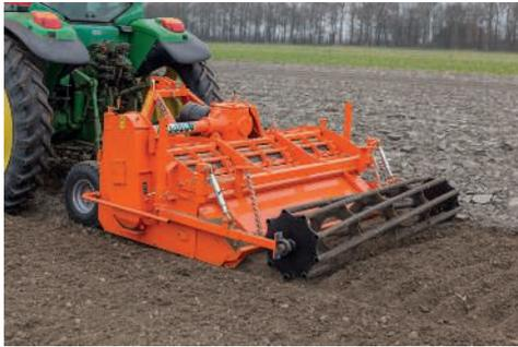
Die RF-Fräse kann einfach zu einer Vollfeldfräse umgebaut werden.
