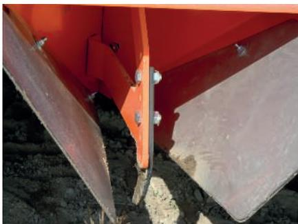
Zinken am Dammformblech sorgen für einen verbesserten Wasserabfluss zwischen den Dämmen. Der so gebildete lockere Boden verhindert ein Eintrocknen der bearbeiteten Furche.
