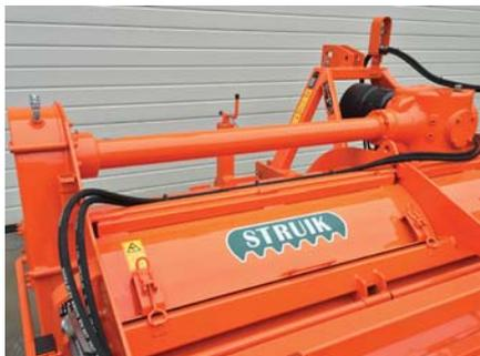
El RF roto-cultivador con púas de gancho está diseñado para tractores de gran potencia. La transmisión combina una caja de cambio con una cadena de transmisión.
