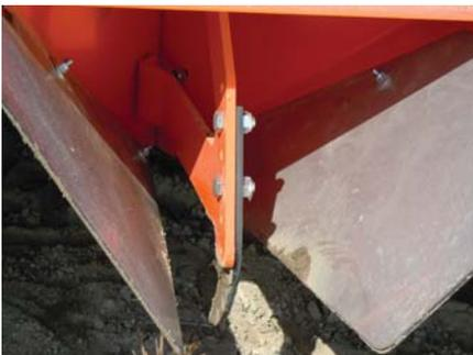
Los subsoladores en el conformador proporcionan mejor drenaje de agua entre los camellones. La tierra suelta adicional que se crea evita que el surco trabajado se seque.
