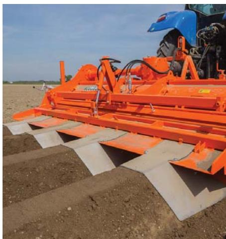
Se puede equipar la unidad de camellones con un regulador automático que mantiene una presión constante sobre el conformador de camellones, lo que resulta en un camellón duradero y rígido.
