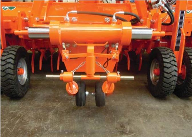
El sistema de control hidráulico construye el camellón de tal manera que garantiza las papas que plante se ubiquen exactamente en el centro del camellón, reduciendo el número de tubérculos verdes.
