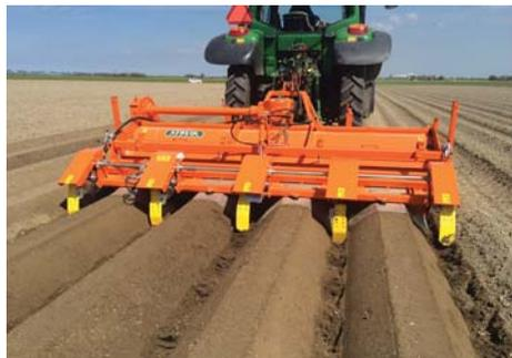
Garantiza un rendimiento más alto al evitar el escurrimiento del agua hacia las partes más bajas del campo – la lluvia se mantiene donde cae. Los reservorios son totalmente ajustables a sus requerimientos y son independientes de la velocidad de avance.
