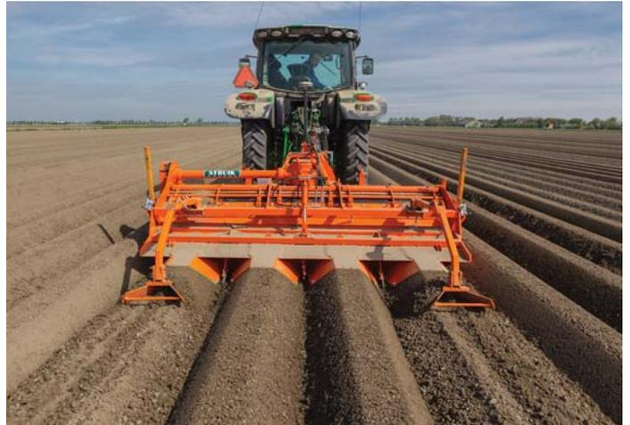
Fácil y rápida construcción de pasillos de circulación mediante los borradores de camellones manuales ó hidráulicos.
