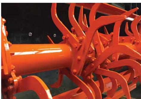
Para la óptima distribución del suelo, la disposición de las púas están distribuidas al azar. Esto proporciona una disgregación uniforme y evita que la tierra se desplace hacia un lado.
