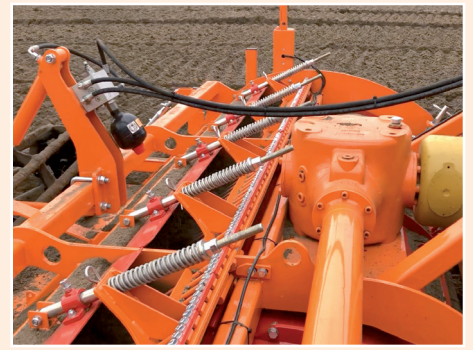
Schweres Getriebe 280 PS/205 kW
